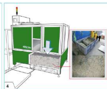
4 - Выгрузка перемолотых/стерилизованных отходов в контейнер
